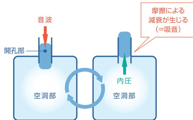
音波が入射すると音波に押された空洞部の空気は圧縮と膨張を繰り返してバネとして働きます。ある特定の周波数で開孔部の空気が激しく振動(共鳴)し摩擦損失によって空気の振動が急速に減衰します。これが吸音作用です。
