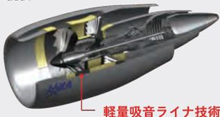
テクセルSAINTは、岐阜プラスチック工業株式会社が開発した吸音材です。ハニカム構造の表面に微細な穴を設けることで、優れた吸音性能を実現しました。JAXAやIHIとの共同研究を通じて航空機軽量吸音ライナへの応用も検討されている最先端の素材です。
