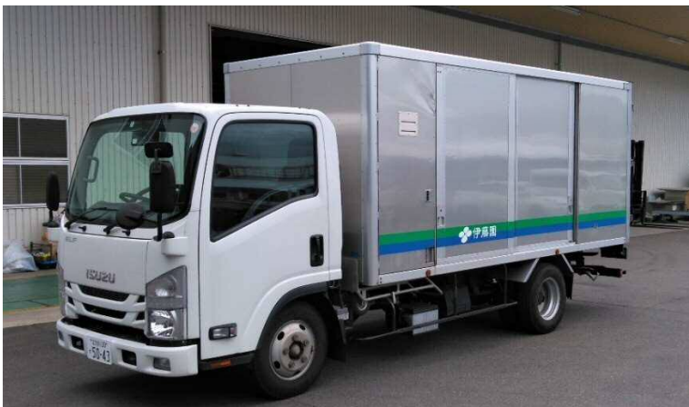
110kgの軽量化に成功したモデル車両（架台のドアパネル、床材に「茶殻配合軽量パネル」を使用）と、茶殻配合軽量パネル（茶殻配合 TECCELL）
