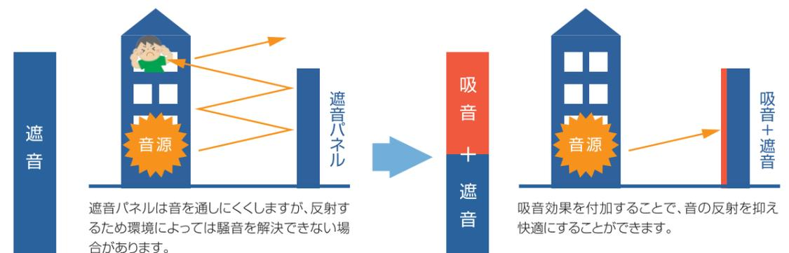
この様に防音対策には「吸音」と「遮音」の組み合わせが適しています。
