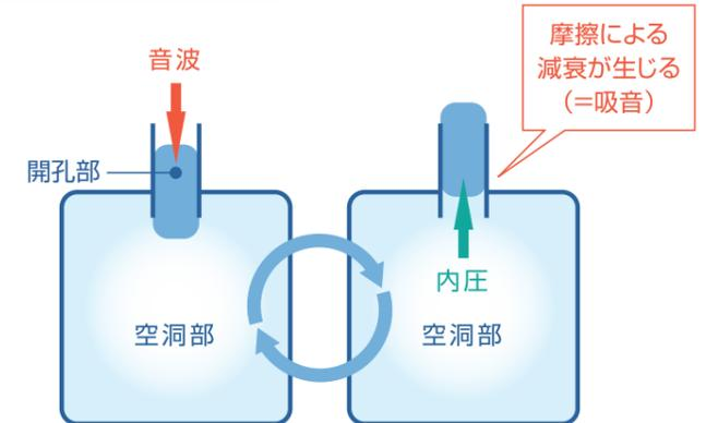
音波が入射すると音波に押された空洞部の空気は圧縮と膨張を繰り返してパネとして働きます。ある特定の周波数で開孔部の空気が激しく振動(共鳴)し摩擦損失によって空気の振動が急速に減衰します。これが吸音作用です。
