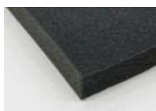
ウレタン（吸音材） 高音域の吸音特性に優れる
